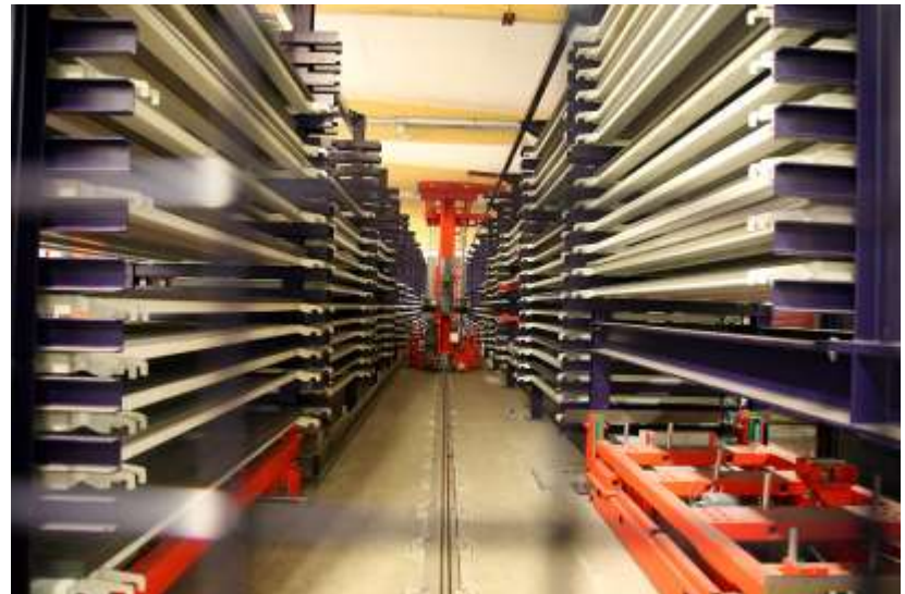
Helautomatiskt lagersystem med lastkapacitet på 1 200 t försörjer lasermaskinerna.
