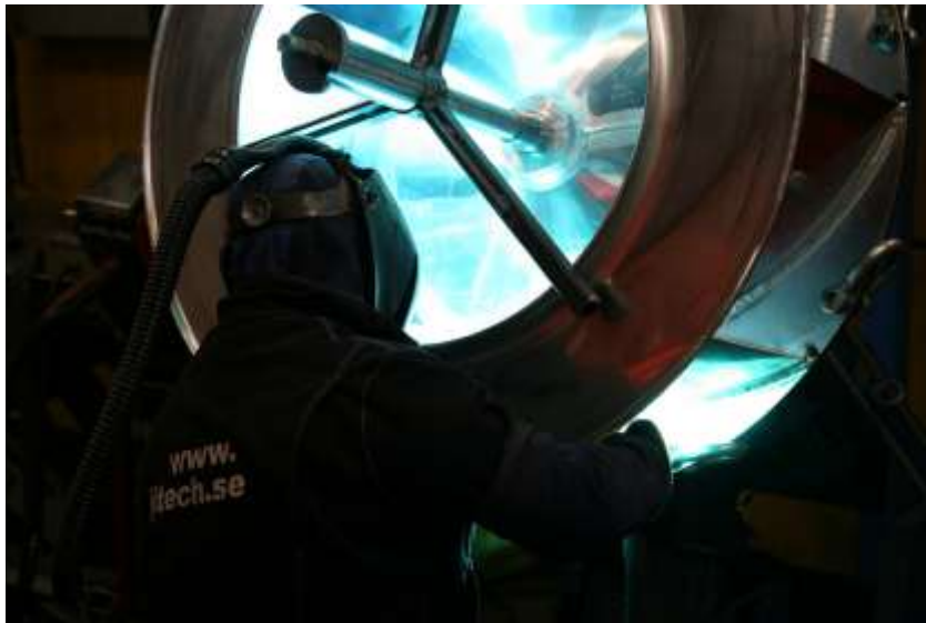
Schweißen eines Aluminiumlüfterrades.
