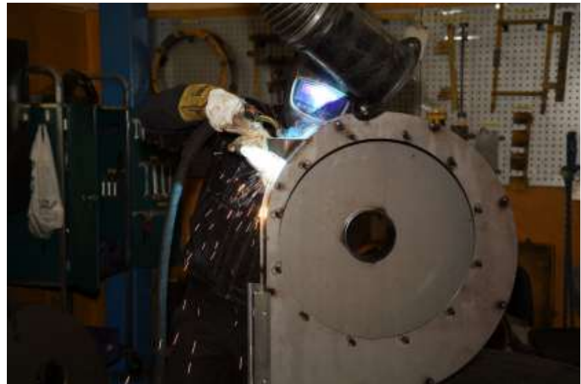
Schweißen eines Lüftergehäuses.
